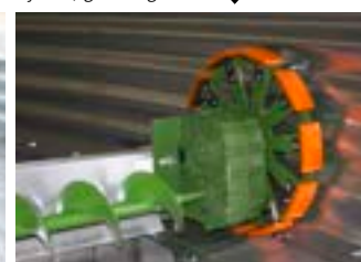
Fejesneglen kan også leveres med ekstra reduceret hastighed på træk hjulet, gearing 16:1 ▼
