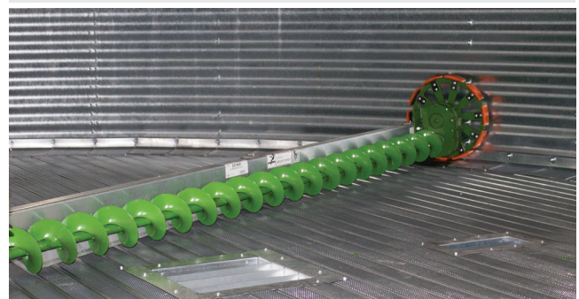
Fejesneglen kan også leveres med ekstra reduceret hastighed på træk hjulet, gearing 16:1 ▼
