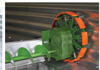
Fejesneglen kan også leveres med ekstra reduceret hastighed på træk hjulet, gearing 16:1 ▼
