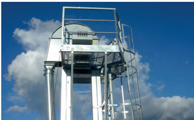
▲ Til fritstående kopelevatorer kan leveres serviceplatform ved elevatorstop samt lejder med rygbojle på elevatorrør.
