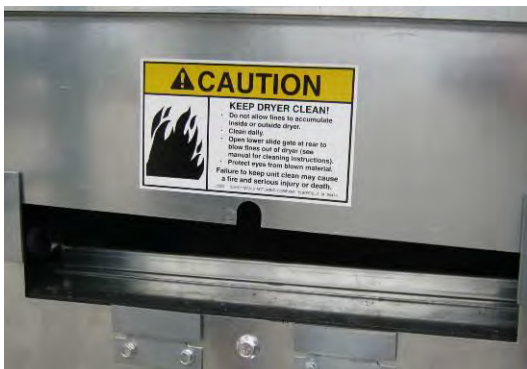
Image 29 – Plenum cleanout/blowout door
